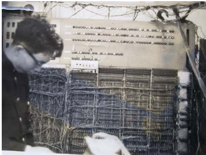
PC-1:パラメトロン計算機、1958稼働、2MHz、512 words
